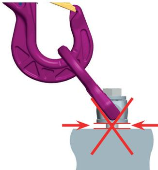
Abb. 7: Der Anschlagpunkt muss vollständig eingeschraubt sein.
