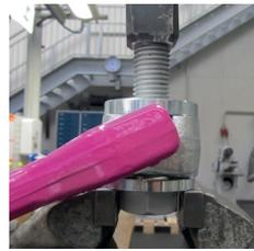
Abb. 12: Auflage des ACP zur Demontage der Schraube
