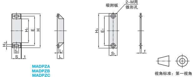
▲MADPZB: 表面电阻率:  $2 \times 10^{10} \Omega/\text{sq}$ , 体积电阻率:  $9 \times 10^{10} \Omega\text{-cm}$
