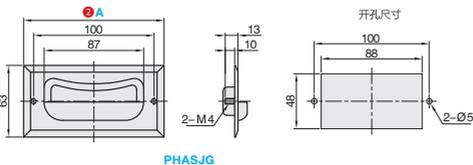
❖ 特点: 采用重量轻, 耐腐蚀性优异的钛合金制。适用于需要轻量化、防锈的场所。钛不易产生金属过敏, 使用安全。另备钛合金安装螺钉。
