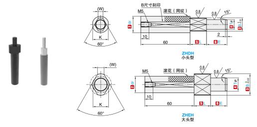
▲ 各段连接部带有宽度为 1mm 左右的退刀槽深约为 0.2mm, 前端部带有中心孔。▲ 产品手柄有时和销黏连在一起, 若对其加热或施加外力, 可能会导致脱落。▲ 大头型无特别注明尺寸同小头型。
