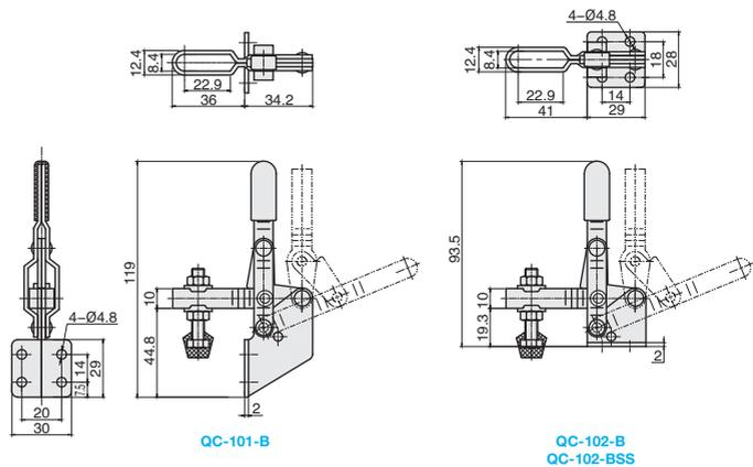
★ 产品特点：主体材质Q235，压把开启角度：90度，手柄开启角度：65度
