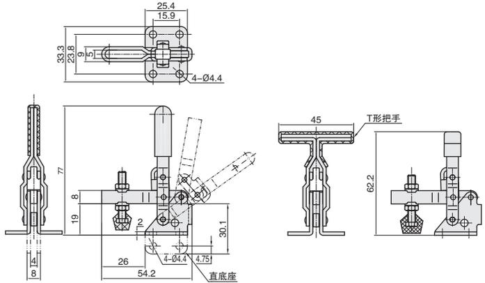
★ 产品特点：主体材质Q235，压把开启角度：100度，手柄开启角度：56度
