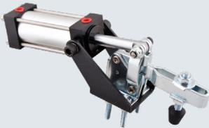
★ 产品特点: 夹头主体材质Q235, 压把转角92°, 省力, 可以自由调节压杆螺栓长度, 锁死后不会松动。
