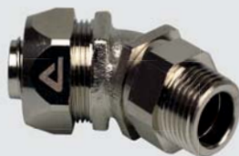
NPT 45° drehbare Winkel Verschraubung, Aussengewinde, Messing-vernickelt, IP 67
