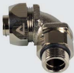
Raccordo ISO maschio girevole 90° in ottone nichelato (incluso adattatore per UIG/UI)
