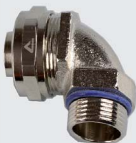
Raccordo compact Pg maschio fisso 90° in ottone nichelato (incluso adattatore per UIG/UI)
