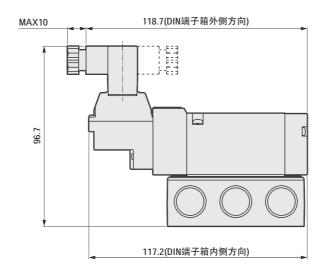
注: DIN端子箱组件向内安装发货。
