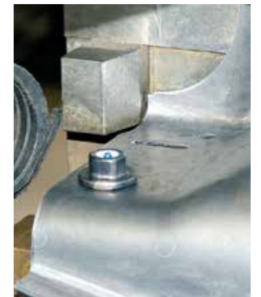
Blech und Buckelmutter für einen
