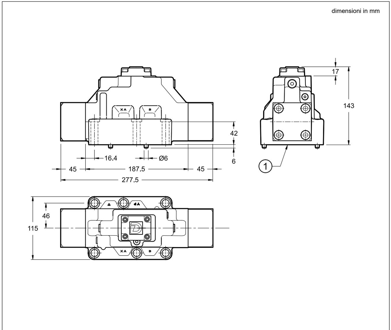
**NOTA:** Per le valvole in versione H (alta pressione), si prescrive l'impiego di viti di fissaggio in classe 10.9
