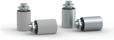
**Beschreibung:** Mit den H2OMIT-Ablassventilen kann angesammeltes Wasser über die Unterseite eines Schaltschranks abgelassen werden. Die Ablassventile dienen auch als Luftdruckausgleich, wodurch die schädlichen Auswirkungen von temperaturbedingten Vakua, die Wasser und Feuchtigkeit in den Schaltschrank saugen können, reduziert werden.
