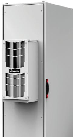
**Beschreibung:** SpectraCool mit erweitertem Korrosionsschutz ist die Klimaanlage für Umgebungen, die rauen, korrosiven chemischen Elementen ausgesetzt sind. Die Einheiten verfügen über ein aktives Kondensatmanagement. Der reinigungsfähige, wiederverwendbare Aluminiumfilter schützt die Spulen für maximale Kühlleistung. Der mechanische Thermostat befindet sich in der Einheit. Die Werkseinstellung beträgt 27 °C.
