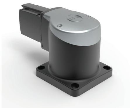
**Información adicional:** La unión de montaje soporta el sistema de suspensión en una superficie horizontal. El ángulo de rotación del brazo es de 300 grados. Incluye tope de seguridad y rodamiento exentos de mantenimiento. Acabado en negro RAL 9005. Construcción en aluminio fundido. Incluye una cubierta de acceso al cable extraíble, instrucciones de instalación, juntas y tornillos. No se suministran los componentes de montaje sobre superficie.
