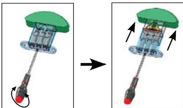
Les ressorts peuvent être libérés suivant la force souhaitée, en commençant par celui du milieu, laissant le tendeur venir en pression sous la chaîne (ou courroie). Il existe 2 types de ressorts différents.
