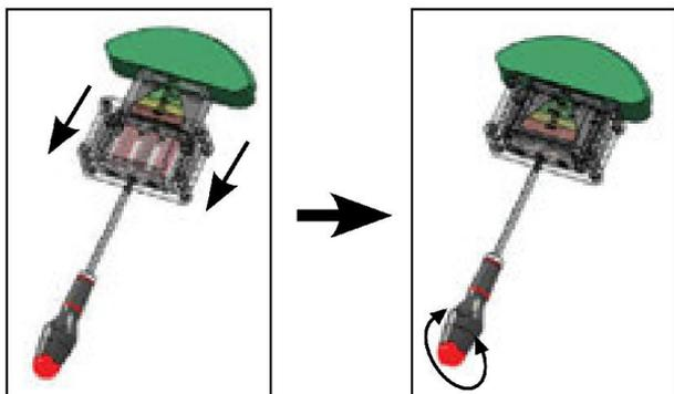
Pré-contraindre le tendeur par l'intermédiaire des vis situées sous le corps.
