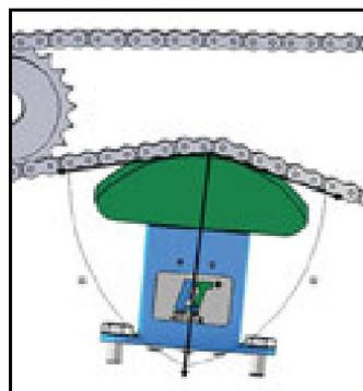
Une fois que les angles du tendeur sont équidistants par rapport à la chaîne ou à la courroie, le mettre en pression manuellement, puis fixer.
