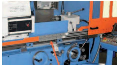
drylin® NT-LM in Schutztürverstellung in Werkzeugmaschine
