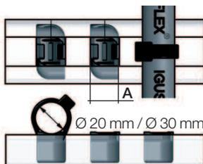
**Zugentlastungsstein - Chainfix Nugget für C-Profil und Hutschiene**
