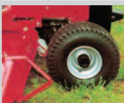
Bild 4.4: Korrosionsbeständigkeit und Schwingungsdämpfung sind die Gründe für den Einsatz als Radlager an Rasenmähern.
