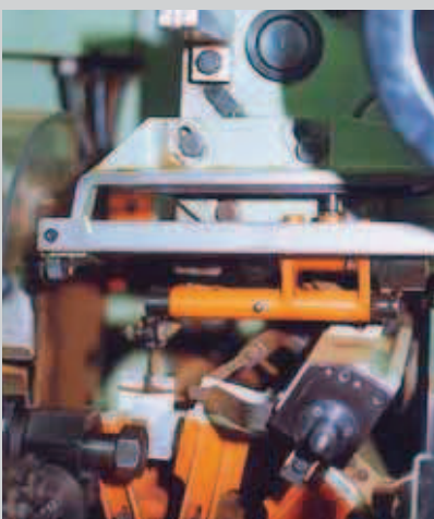
Bild 5.1: Durch die Umstellung auf iglidur® W300 konnte die Lebensdauer der Lager an dieser Teebeutelabpackmaschine vervielfacht werden.
