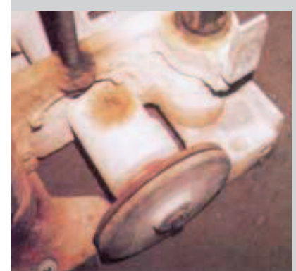
Bild 5.3: iglidur® W300: höchste Verschleißfestigkeit auch dort, wo abrasive Medien die Lagerstelle beeinflussen
