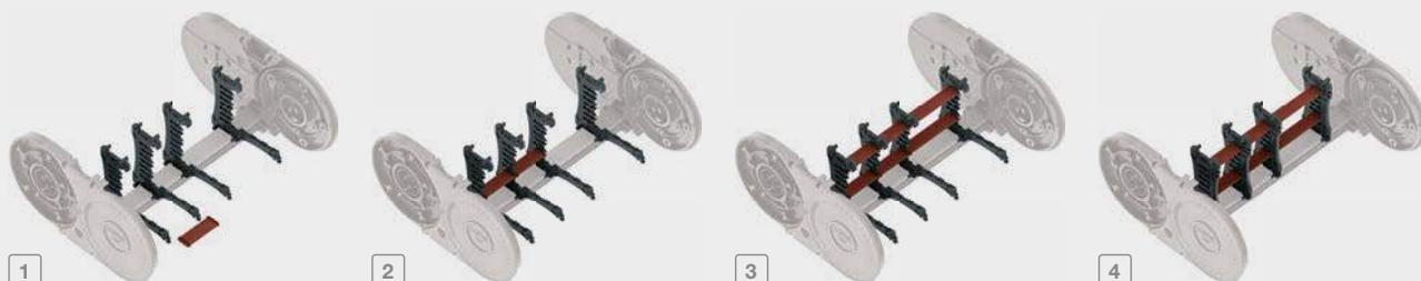
1 Leitungen einlegen, Trennsteg aufklappen und erste Höhenunterteilung einschieben
