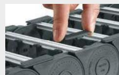
Auswechselbare Gleitschuhe aus Kunststoff
