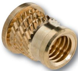
Der Mubux®-A ist ein Gewinde-Einsatz bzw. ein Gewindestift mit mehrfach-schrägverzahntem, konischem Verankerungsprofil und einem Führungsansatz zum problemlosen Eindrücken.
