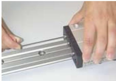
2. Stellen Sie mit einem Inbusschlüssel das Lagerspiel für die drei Führungspunkte nach. Schlüsselweite:
