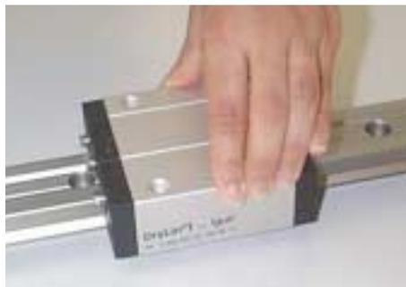
3. Prüfen Sie nach dem Einstellen das Spiel der Führungsschlitten. Ist es ausreichend, Kontermuttern festdrehen und Schutzkappen aufsetzen.
