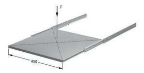
Bei einem größeren Schienenabstand muss jeder Anwender ermitteln, ob die Schienen für die jeweilige Anwendung geeignet sind.
