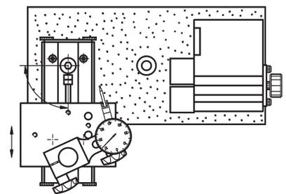
Die Verstellung des Schlittens ist mittels einer Schraube möglich. Die beiden Positionsbohrungen ermöglichen einen vergrößerten Arbeitsraum.
