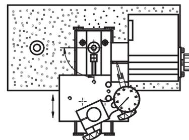
Der Schlitten kann variabel um 90° verdreht werden und ermöglicht somit ein schnelles Wegfahren und Positionieren beim Teilewechsel.
