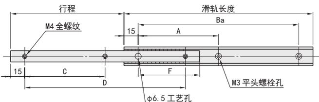
注: A、B为外滑轨的安装孔尺寸
