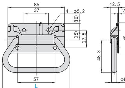
注: 手一离开拉手部, 由于弹簧的作用, 拉手即恢复为图示状态
