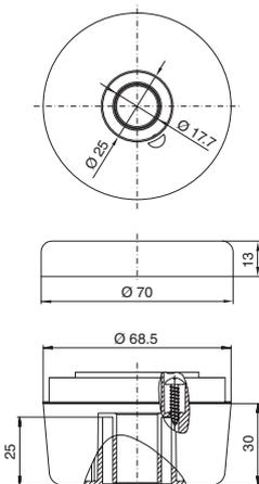
**Anschluss-Element für Wand-/Bodenmontage**
