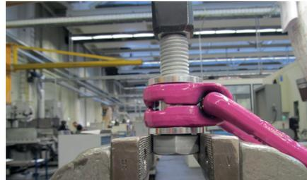
Abb. 8: Auflage des VLBG-PLUS zur Demontage der Schraube
