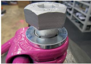
Abb. 10: Sprengring umlaufend vertieft in der Ansenkung positioniert
