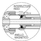
Il campo magnetico dell'anello, fissato alla madrevite, aziona il contatto reed dell'interruttore fissato con una fascetta al tubo di protezione.
