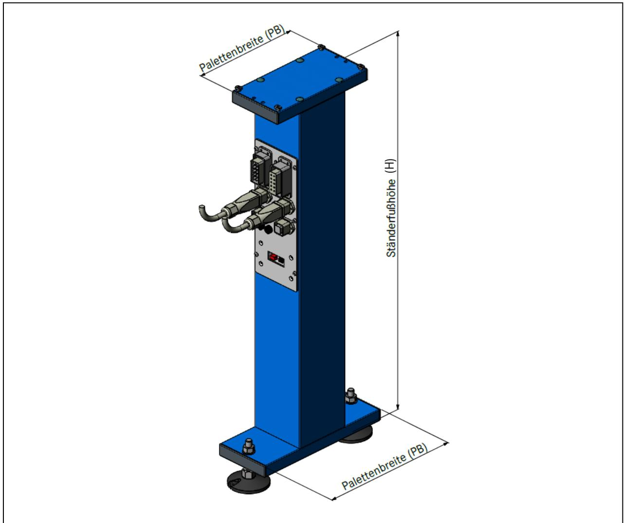
Der Ständerfuß dient zur Auflage und Unterstützung der Bandlelemente. Zusätzliche Ausstattung. Leistungseinheit für die Spannungsversorgung der Motoren.
