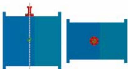
Im Werkzeugschwerpunkt montiert
