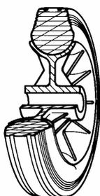
**Ruota:** Rivestimento costituito da un anello calettato in gomma standard; durezza 85 +/- 3 Shore A.
